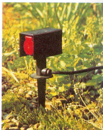
Fröccsenő víz ellen védett kivitelű földelt, csapófedeles dugaszolóaljzat, tömített kábelcsatlakozással, földbe szúrható rögzítőtűskével
