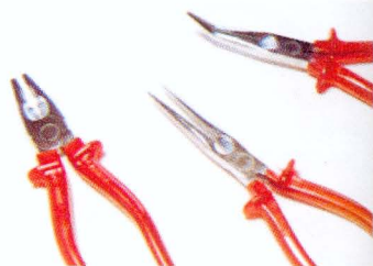
Különböző célú fogók: hajlított hosszúcsőrű és egyenes hosszúcsőrű fogó, valamint kombinált fogó (a kép bal oldalán)
