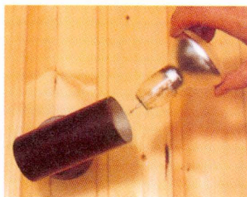
Az izzólámpáról a menetes rész letört, és bennmaradt a foglalatban
