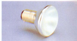
Törpefeszültségű halogén reflektorizzó bajonettzáras lábazattal (Magyarországon még nem szokásos): 1-es nagyság 15 és 20 W teljesítményre, 2-es nagyság 35 és 50 W teljesítményre, feszültség 6 és 12 V. Az izzó homloküvegét sérülések ellen védőbevonattal látták el. Felhasználják finom munkák helyi, vagy kis terület hangulatos, erős megvilágítására
