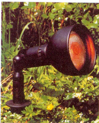
Állítható külső világítás, fröccsenő víz ellen védett kivitelben, földbe szúrható rögzítőtűskével
