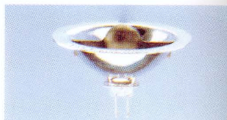
Törpefeszültségű halogén reflektorizzó 12 V feszültségre. A lámpatestet úgy alakították ki, hogy a fény irányított és sugárszerű legyen. Felhasználási terület: lakásrészek fokozottabb megvilágítása, kirakatok és kiállítási tárgyak megvilágítása
