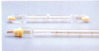
Kétoldali csatlakozással kialakított halogén ceruzaizzó 220 V feszültségre. Teljesítménye 100...2000 W transzformátor nélkül működik. Alkalmazzák: fényvetőkben, ha nagy fényerősségre van szükség. Pl. házak külső megvilágításánál, vagy ingatlanterület kivilágításánál
