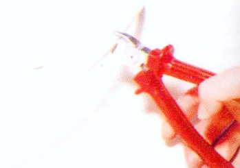
Közepes nagyságú oldalcsípő fogó, a vezetékek levágására
