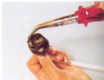
A foglatban lévő oldalérintkező kissé elgörbült, fogóval megigazítjuk
