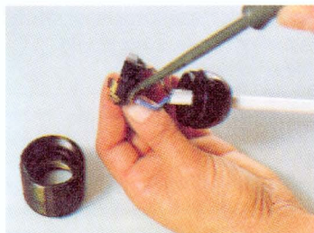
A lámpafoglatat csatlakozásainak és érintkezőinek átvizsgálása
