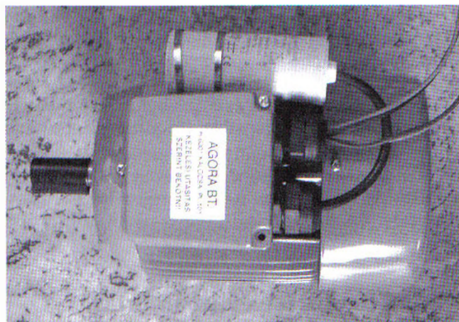
6.5.2. ábra. Egyfázisú aszinkronmotor indításához és fázisjavításához alkalmas kondenzátor bekötése
