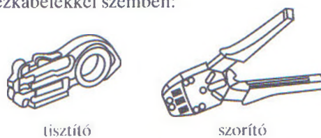
3.4.4. ábra. Vezetékvég tisztító és szorító szerszám
