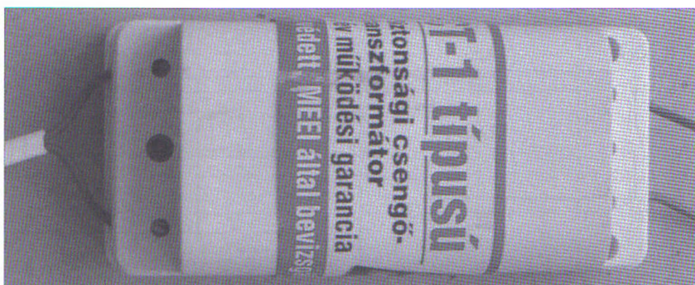
3.2.1. ábra. Biztonsági csengő transzformátor
