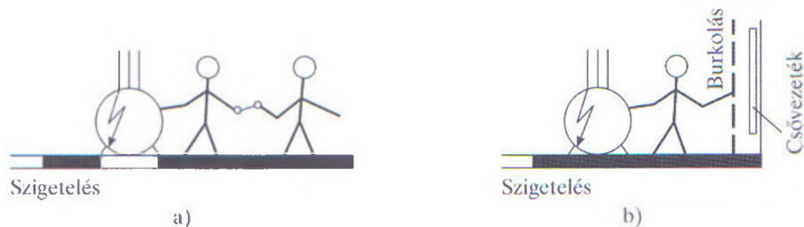
2.4.5. ábra. A környezet elszigetelésének módjai
