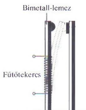
4.4.2. ábra. Bimetal nyugalmi állapotban
